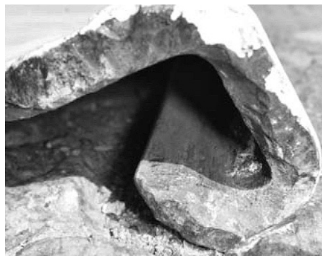
Рис. 5. Замок шпунтовой сваи после ее извлечения
